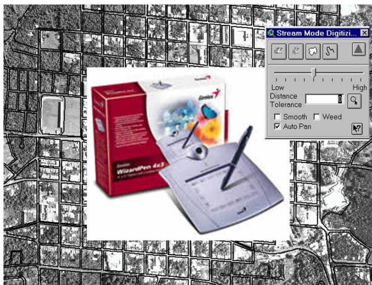
Figura 3.9. Herramientas utilizadas para vectorizar elementos desde una foto aérea (formato ráster).
