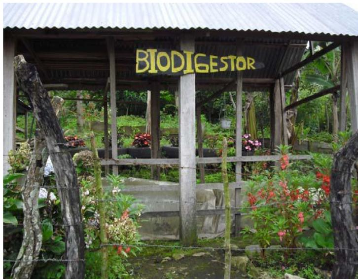
Es en su forma más simple, un contenedor cerrado, hermético e impermeable (llamado reactor), dentro del cual se deposita el material orgánico a fermentar (excrementos de animales y humanos, desechos vegetales-no se incluyen cítricos ya que acidifican-, etcétera) en determinada dilución de agua para que se descomponga, produciendo gas metano y fertilizantes orgánicos ricos en nitrógeno, fósforo y potasio.
