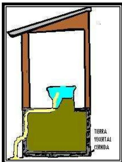
Antes de usar el sanitario, extienda una capa de 5 cms. de espesor de tierra vegetal sin terrones en el piso de la cámara
