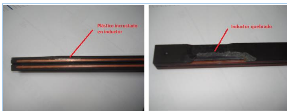
Figura 25. Efecto de la pérdida de corrección sobre de inductores de llenadoras con flexi cap, plástico de tapa incrustado en inductor e inductor quebrado.
