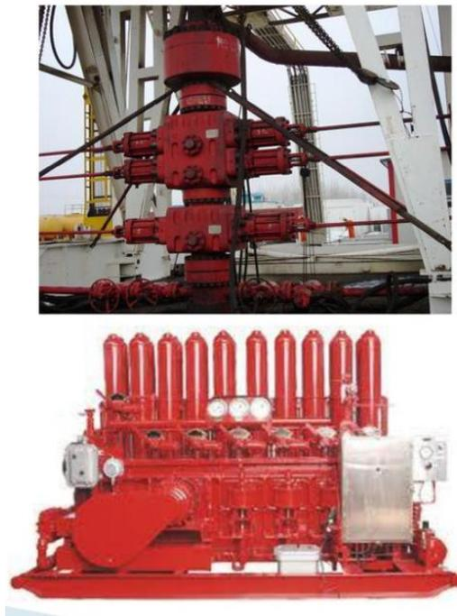
Figura 14 Sistema de prevención de reventones, arriba el preventores anular y de doble martinete, abajo los acumuladores.
