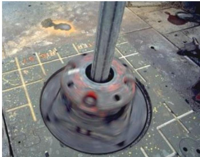
Figura 11 Componentes del sistema de rotación, mesa rotaria, buje de la flecha y flecha (Schlumberger, 2019)
