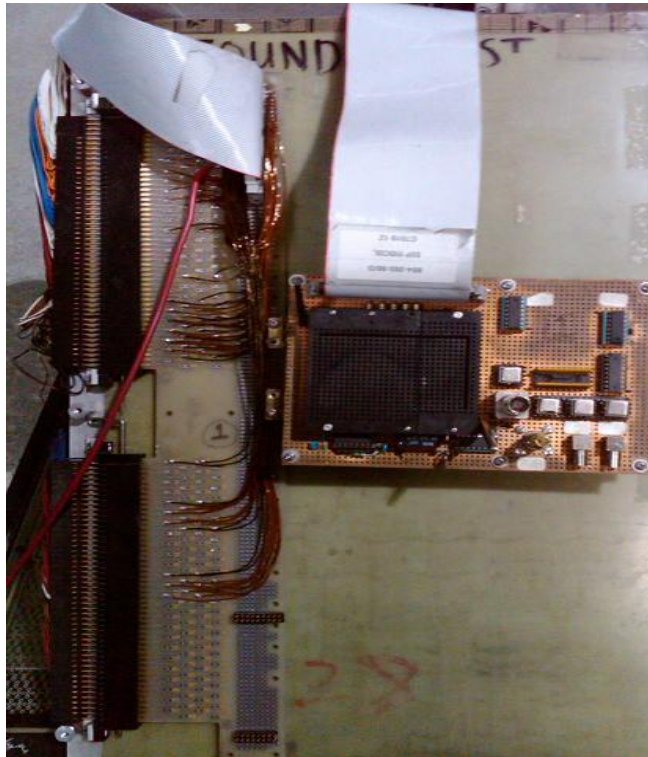
Figura 7. Fixture de pruebas para los PEM. Fuente: Foto del autor (2018)
