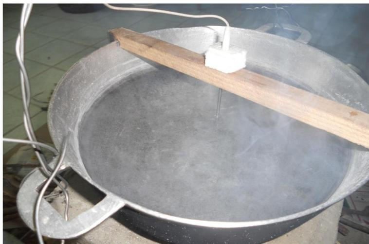
**Figura 16:** Olla con termómetro en prueba a estufa Isleña en ambiente controlado.
