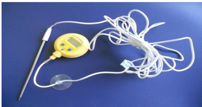
**Figura 14:** Termómetro digital AQA1411 para agua (Water Resistant Thermometer).
