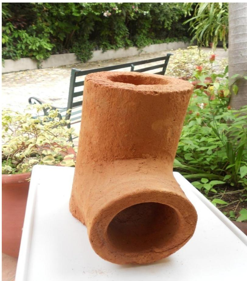
**Figura 5:** Cámara de combustión refractaria.
