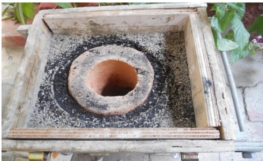
**Figura 11:** Cámara de combustión rodeada de aislante
