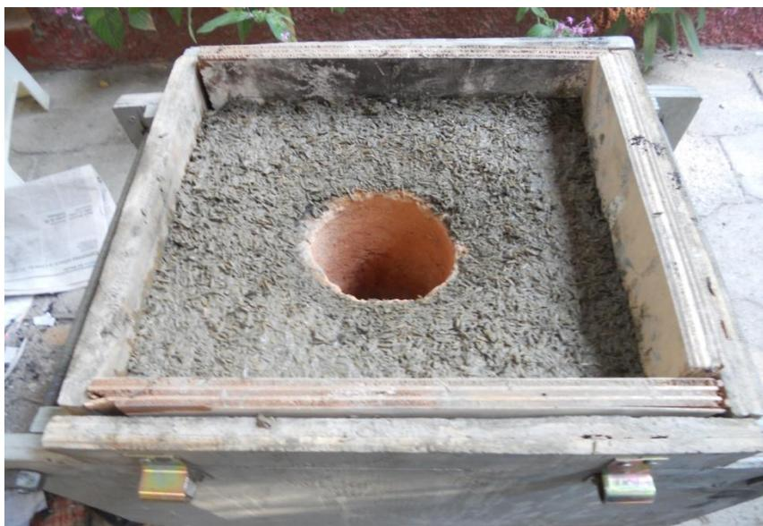
**Figura 12:** Estufa lista para sacar del molde y darle terminación.
