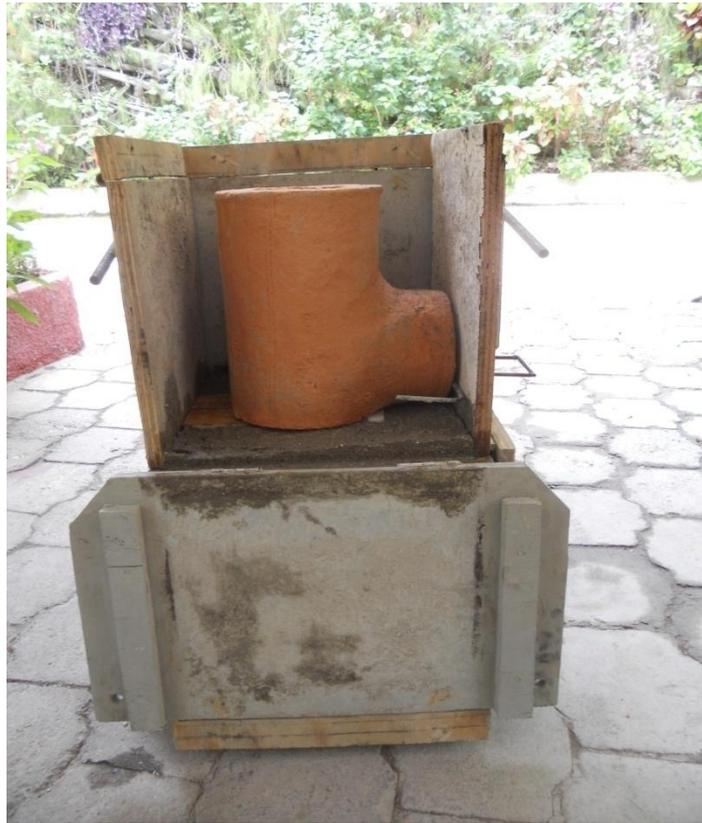
**Figura 9:** Cámara de combustión en el molde.
