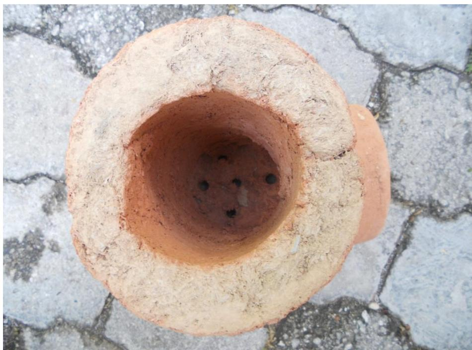
**Figura 6:** Huecos en la base de la cámara de combustión.
