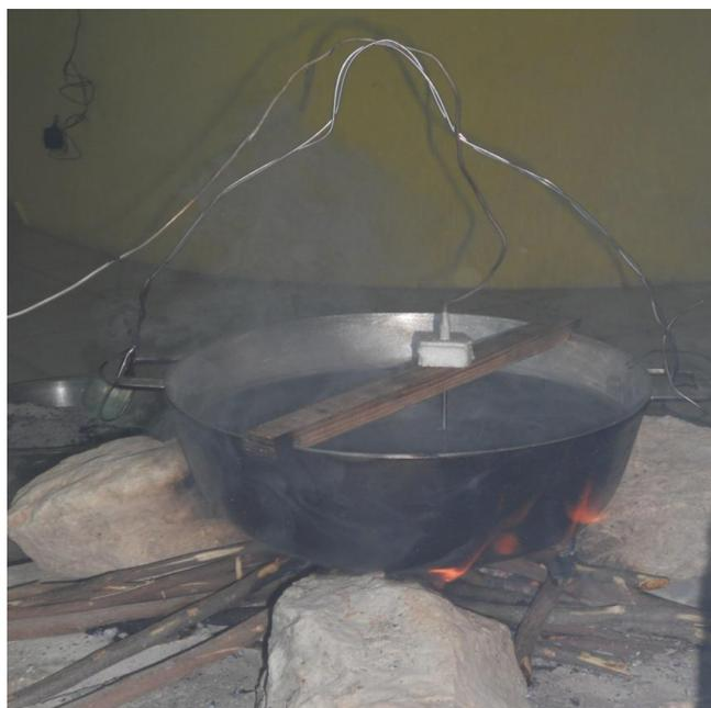
**Figura 15:** Olla con termómetro en prueba a fuego abierto en ambiente controlado.
