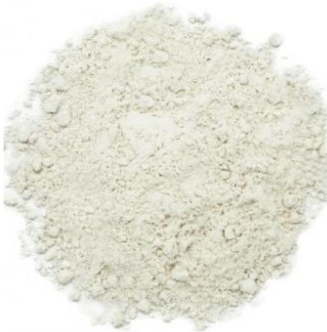
**Figura 6 Arcilla refractaria, insumo principal para la fabricación de crisoles refractarios. (Fuente: Elaboración Propia)**
