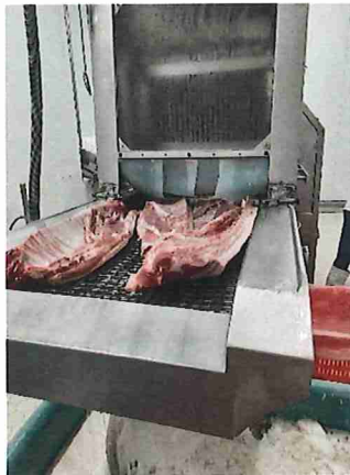
Figura 9. Inyección de salmuera
