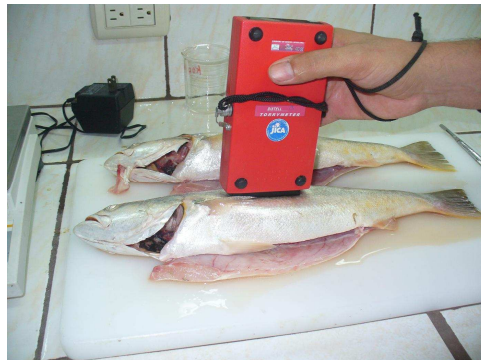
Figura 7. Determinación de la frescura mediante la medición de la resistencia dieléctrica en la carne de corvina picuda ( C. phoxocephalus ) con GR Torrymeter.
