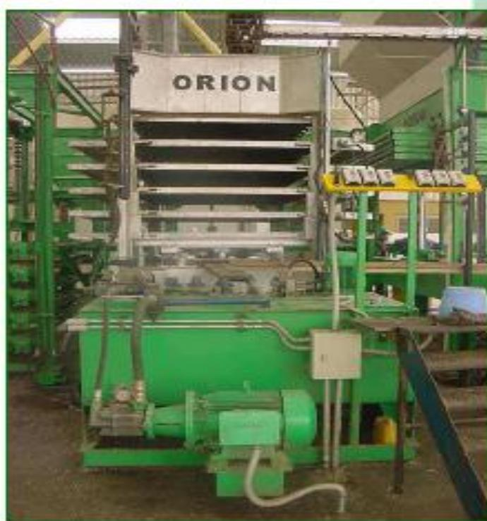
Figura 29. Ejemplo de prensa hidráulica necesaria para el prensado en caliente y en frío.
