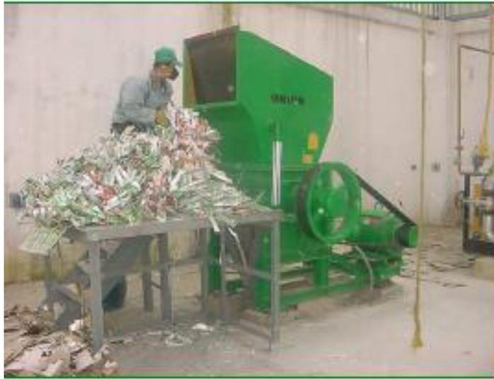
Figura 28. Ejemplo de trituradora necesaria para el proceso de molienda de los envases tetra brik.
