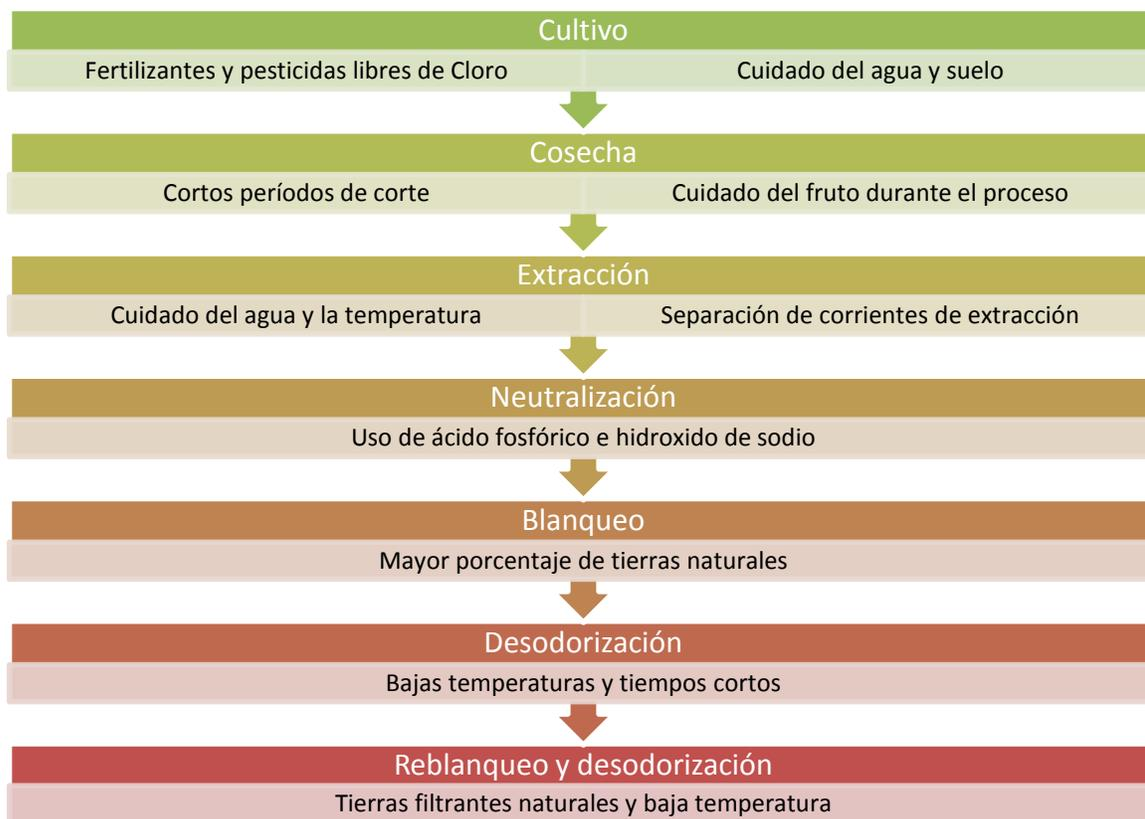
**Figura 11.** Diagrama de flujo del proceso de producción de aceite de palma con medidas de control.
